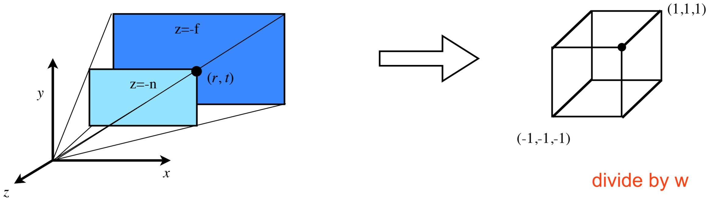
$$\begin{bmatrix} \frac{n}{r} & 0 & 0 & 0 \\ 0 & \frac{n}{t} & 0 & 0 \\ 0 & 0 & -\frac{f+n}{f-n} & \frac{-2fn}{f-n} \\ \boxed{0} & \boxed{0} & \boxed{-1} & \boxed{0} \end{bmatrix} \begin{bmatrix} x \\ y \\ z \\ 1 \end{bmatrix} = \begin{bmatrix} x_c \\ y_c \\ z_c \\ w_c \end{bmatrix} \xrightarrow{\text{divide by } w} \begin{bmatrix} \frac{x_c}{w_c} \\ \frac{y_c}{w_c} \\ \frac{z_c}{w_c} \\ 1 \end{bmatrix}$$
